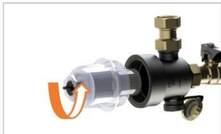
Vyšraubovať proti smeru hodinových ručičiek maticu držiaku magnet pomocou kľúča 29mm. Ubezpečte sa, že voda vytečie do nádoby o vhodnej veľkosti.
