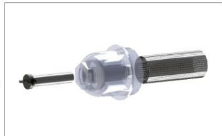
Vyšraubovať proti smeru hodinových ručičiek maticu držiaku magnet pomocou kľúča 29mm. Ubezpečte sa, že voda vytečie do nádoby o vhodnej veľkosti.
